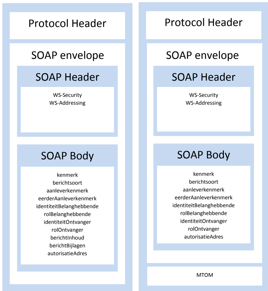
Figuur 2 SOAP Request voor de Aanleverservice (met en zonder gebruik van MTOM)
